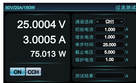
▲ N61100用于OCP测试中
